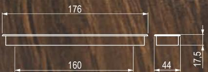
Model is designed primarily for sliding doors. / Model určený primárne pro posuvné dvere. / Model určený primárne pre posuvné dvere. / Model przeznaczony przede wszystkim do drzwi przesuwnych. / Elsősorban tolóajtókhöz tervezett modell. / Das Modell wurde hauptsächlich für Schiebetüren entwickelt.
