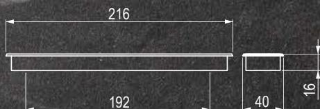
● Model is designed primarily for sliding doors. / Model určený primárne pro posuvné dvere. / Model určený primárne pre posuvné dvere. / Model przeznaczony przede wszystkim do drzwi przesuwnych. / Elsősorban tolóajtókhoz tervezett modell. / Das Modell wurde hauptsächlich für Schiebetüren entwickelt.
